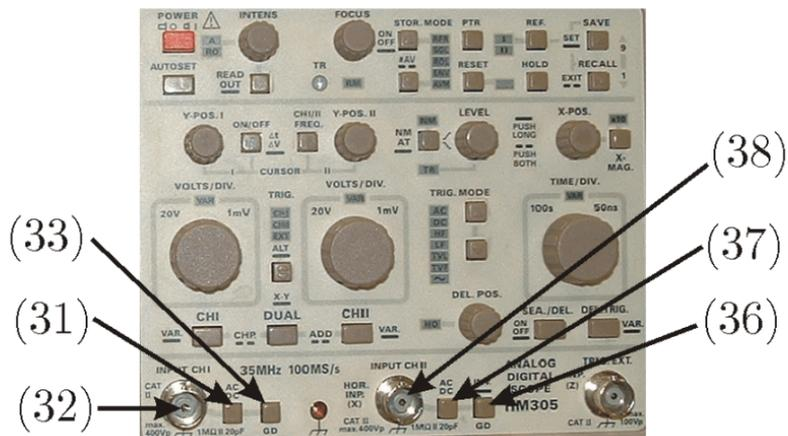
(31) Entrada Canal 1, (32) Acoplo AC/DC, (33) GND, (38) Entrada Canal 2, (37) Acoplo AC/DC del canal 2 y (36) GND del canal 2
