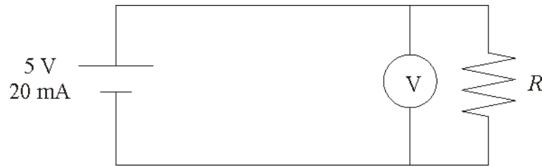
Figura 2.7: Montaje para la medida de la caída de la tensión en la resistencia de la Figura 2.5. El símbolo que tiene una V representa un medidor de voltaje.
