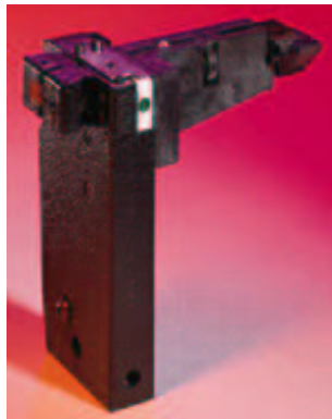
FIGURA 1.14. Fotografía de un sencillo cortador de fibra. Modelo F-CL1 de Newport.
