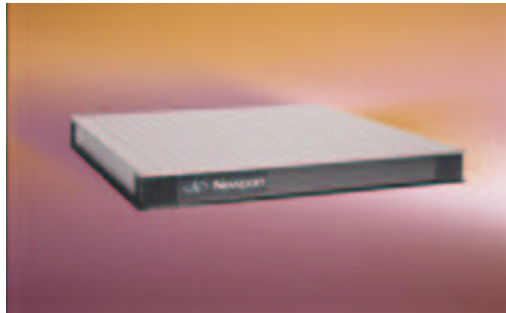
FIGURA 1.7. Fotografía de un tablero óptico donde se situarán los elementos para realizar la práctica y en la fotografía se puede observar los agujeros para poder fijar los diversos elementos con ayuda de tornillos.
