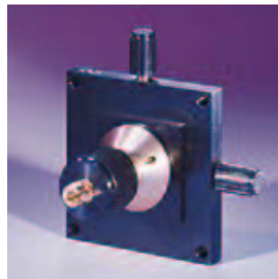
FIGURA 1.22. Fotografía de un posicionador de fibra. En la fotografía se observa perfectamente dos tornillos que sirven para posionar y alinear en las direcciones X e Y la fibra óptica. El alineamiento en Z se consigue introduciendo más o menos el fiador en el posicionador.
